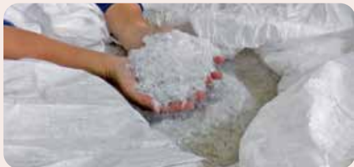
集められたペットボトルを破砕してチップ化
