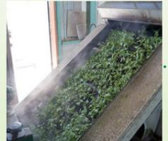
刈り取った茶葉を蒸気で蒸した後、冷却する
