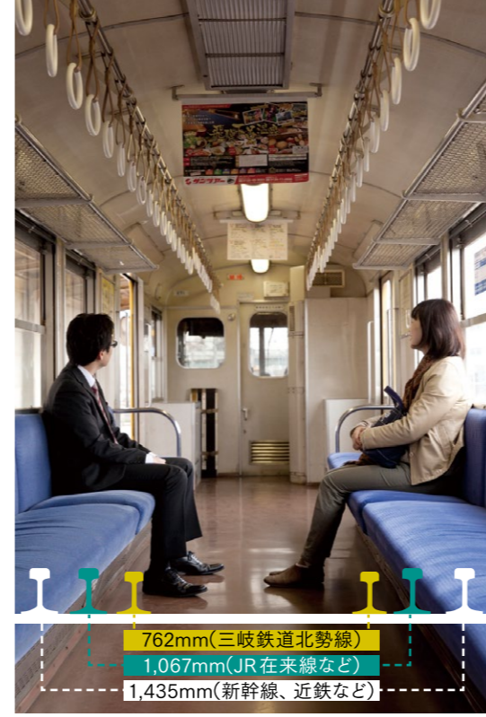
↓ナローゲージの線路幅 北勢線の線路幅、ナローゲージ(特殊狭軌)は762mm。日本の一般的な路線と比較すると、その狭さがわかります。
