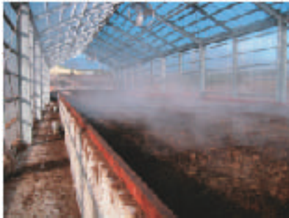
1次処理施設の発酵槽
