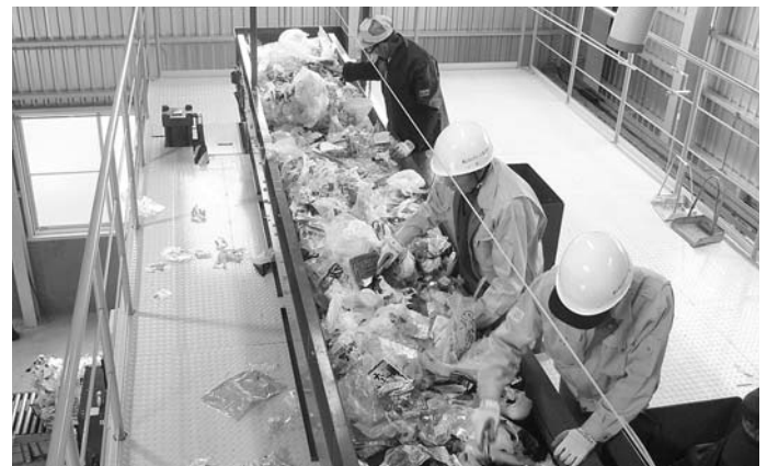
プラスチック圧縮梱包施設
