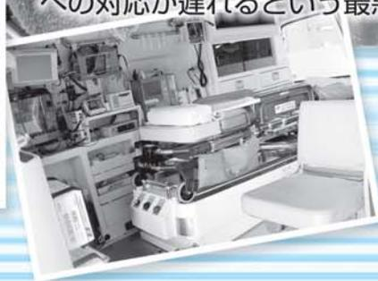
救急車の中は、血圧や脈拍、心電図などが計測できるベッドサイドモニターや、人工呼吸器、AED、点滴を行う輸液ポンプなど高度な救急救命処置もできる装備がされています。
